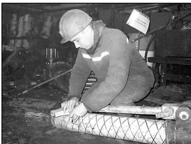
Слесарь-ремонтник Т.В. Головкин проводит ревизию анкеропосадочного станка MQT-120.
